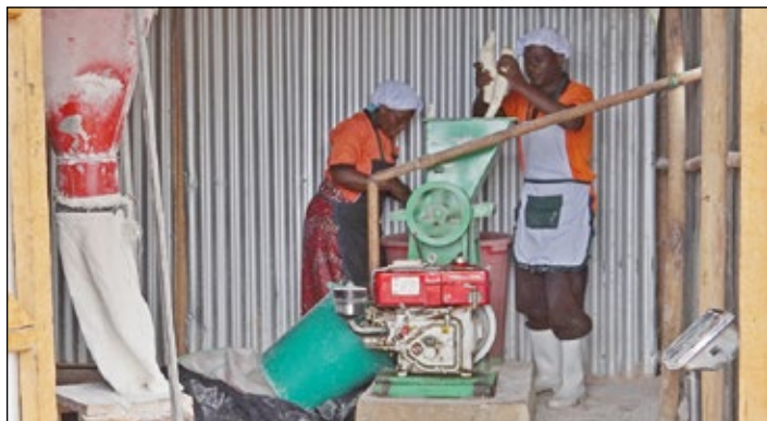
Kassavaverarbeitung mit der Hackselmaschine und der Kassavamühle bei der Kolpingsfamilie Ntoja
